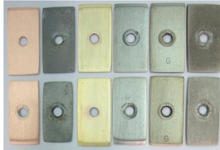
Bild 2: Metallprüfkörper nach ASTM D 1384
