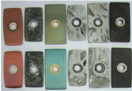
Bild 1: Metallprüfkörper nach ASTM D 1384
