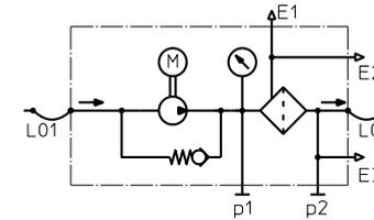
Filtereinheit mit optischer Verschmutzungsanzeige
