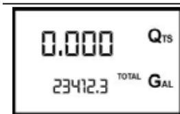
und nach wenigen Sekunden wird Reset Total durch die NICHT nullbare Gesamtmenge (Total) ersetzt.
