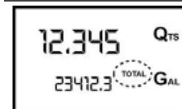
Nach dem Drücken der RESET-Taste zeigt das Display während der Nullstellung nacheinander zunächst alle eingeschalteten Ziffern und dann alle ausgeschalteten Ziffern an.
