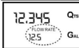
**Die Schrift "Gal" neben der Flow Rate bezieht sich auf das Register der (nullbaren oder NICHT nullbaren) Gesamt-mengen, die erneut angezeigt werden, wenn der Anzeigemodus der Durchflussmenge wieder verlassen wird..**
